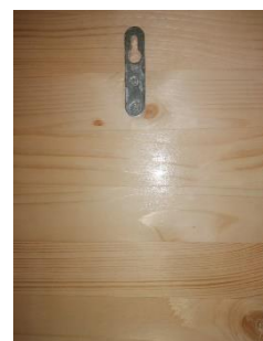
Рис. В.10 – Лакировка обратной стороны изделия, установка креплений.
