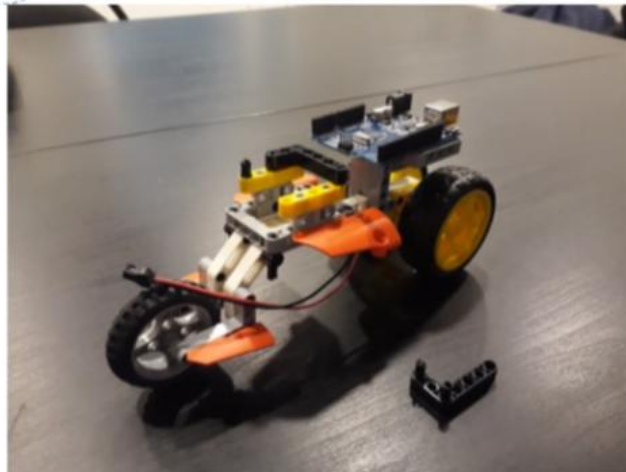
Рисунок 4. Презентация «Инструкция по сборке робота «Трехколесный автомобиль» из конструктора LEGO с использованием контроллера ARDUINO»
